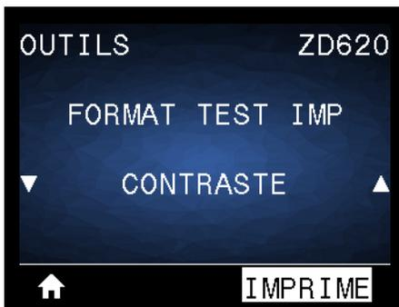
**Description** : cette option permet d'initier des séquences de test qui impriment des types d'étiquettes spécifiques afin de vous aider à résoudre les problèmes d'impression.
