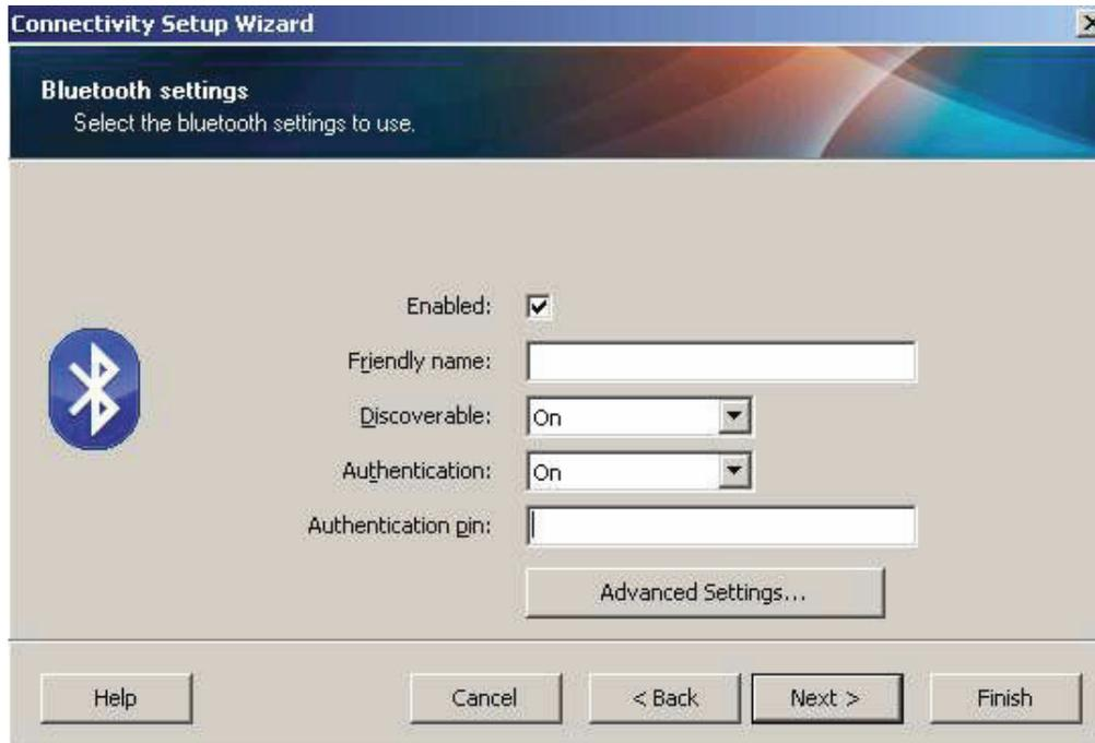
10. Si le périphérique principal utilise BT 2.1 ou une version ultérieure, ce paramètre n'a aucune incidence. En effet, ces versions ont recours au protocole SSP (Secure Simple Pairing), qui ne requiert pas l'utilisation d'un code PIN.
