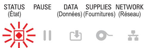
L'imprimante ne reconnaît pas le type de résolution de la tête d'impression (ppp). La tête d'impression n'a pas été installée correctement ou elle provient d'une marque tierce.
