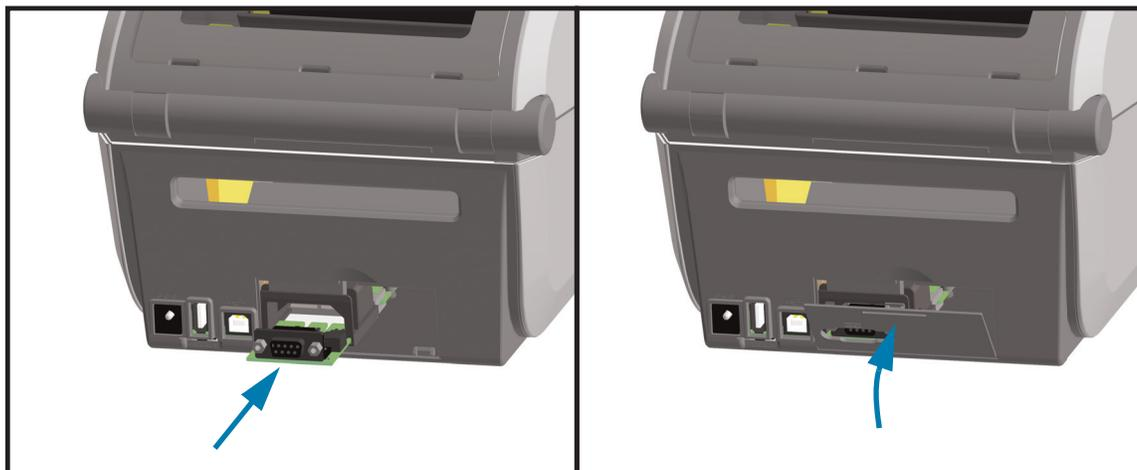
1. Après avoir retiré la fiche d'alimentation CC et le panneau d'accès du module, insérez le module port série dans l'imprimante. Enfoncez doucement, mais fermement la carte de circuit imprimé, jusqu'à ce qu'elle dépasse légèrement du rebord intérieur du panneau d'accès.
