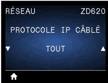
**Description :** ce paramètre indique si l'administrateur/utilisateur réseau (définition permanente) ou le serveur (définition dynamique) sélectionne l'adresse IP du serveur d'impression câblé. Lorsqu'une option dynamique est sélectionnée, ce paramètre détermine les méthodes de réception par le serveur d'impression de l'adresse IP envoyée par le serveur.
