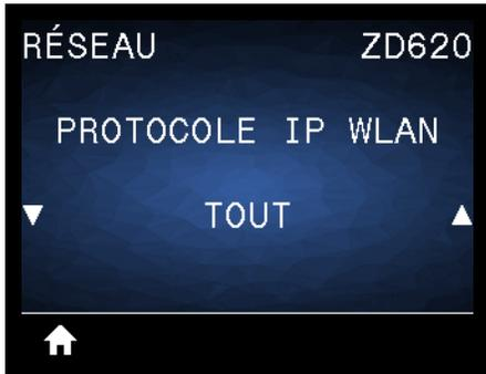
**Description** : ce paramètre indique si l'administrateur/utilisateur réseau (définition permanente) ou le serveur (définition dynamique) sélectionne l'adresse IP du serveur d'impression sans fil. Lorsqu'une option dynamique est sélectionnée, ce paramètre détermine les méthodes de réception par le serveur d'impression de l'adresse IP envoyée par le serveur.
