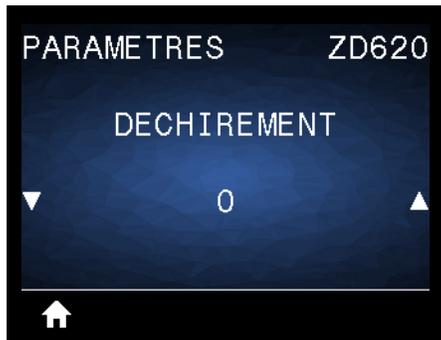
**Description :** ajuste la position de repos du papier après l'impression d'une étiquette. La position de repos ou d'arrêt indique l'emplacement du point de déchirement sur ou entre des étiquettes.
