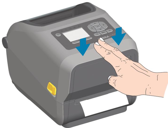
Il se peut que vous deviez procéder au calibrage du capteur de l'imprimante en vue de régler le détecteur d'étiquette, de support et de distance entre les étiquettes pour un fonctionnement correct. Lorsque vous rechargez ce type de papier (même taille, fournisseur et lot), il vous suffit d'appuyer une fois sur le bouton AVANCE pour préparer l'impression.
