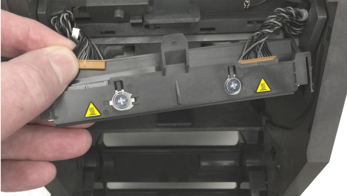
3. Insérez la languette centrale de la tête d'impression dans la fente centrale du bras de positionnement de la tête d'impression.
