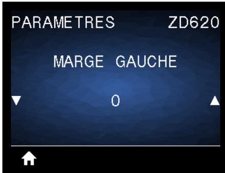
**Description :** si nécessaire, décale horizontalement la position de l'image sur l'étiquette.
