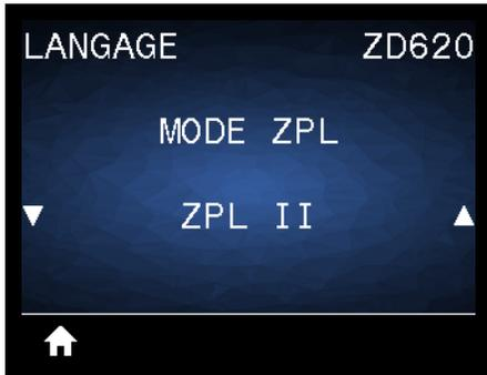
**Description :** sélectionnez le mode correspondant à celui utilisé dans vos formats d'étiquettes. L'imprimante accepte les formats d'étiquettes en ZPL ou ZPL II, ce qui évite d'avoir à réécrire les formats ZPL existants. L'imprimante conserve le mode sélectionné jusqu'à ce qu'il soit modifié de l'une des manières décrites.
