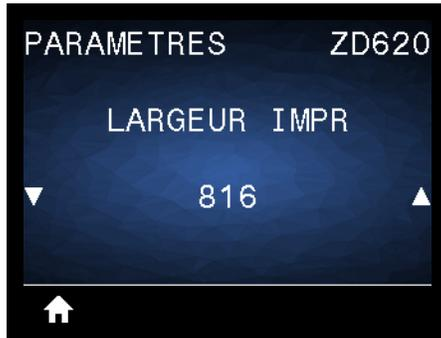
**Description :** indique la largeur des étiquettes utilisées, en points. La valeur par défaut est la largeur maximale de l'imprimante, basée sur la valeur de points par pouce de la tête d'impression.
