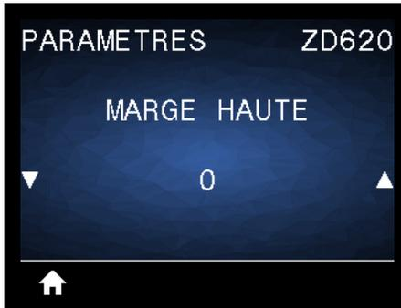
**Description** : si nécessaire, décale verticalement la position de l'image sur l'étiquette.
