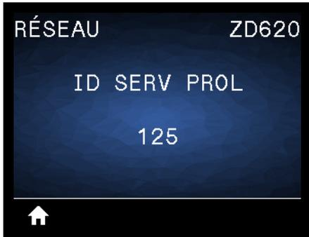
**Description :** l'ID SERV PROL (ESSID, Extended Service Set Identification) est l'identifiant de votre réseau sans fil. Ce paramètre, qui ne peut pas être modifié à partir de l'interface utilisateur, indique l'ESSID de la configuration sans fil actuelle.
