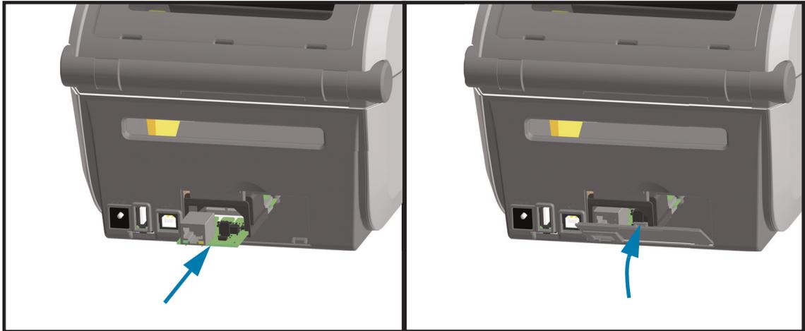
1. Après avoir retiré la fiche d'alimentation CC et le panneau d'accès du module, insérez le module Ethernet dans l'imprimante. Enfoncez doucement, mais fermement la carte de circuit imprimé, jusqu'à ce qu'elle dépasse légèrement du rebord intérieur du panneau d'accès.
