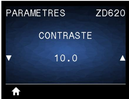
**Description** : configurez le contraste d'impression sur la valeur minimale permettant d'obtenir une bonne qualité d'impression. Un réglage à un niveau trop élevé risque de provoquer une impression floue de l'image de l'étiquette, une numérisation incorrecte des codes à barres, le passage de l'encre à travers le ruban ou l'usure prématurée de la tête d'impression.
