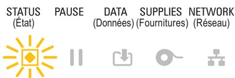
La température de la tête d'impression est insuffisante. En règle générale, la température de l'environnement de fonctionnement est inférieure à la température minimale de fonctionnement de l'imprimante.
