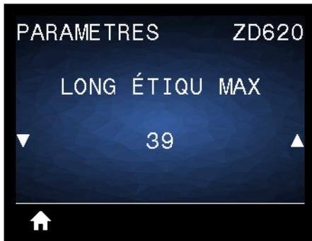
**Description :** ce paramètre contrôle la distance utilisée par les utilitaires de l'imprimante, tels que SmartCal, pour détecter automatiquement les étiquettes (marque noire, encoche ou espace/bande). Si l'imprimante ne détecte et ne calibre pas l'étiquette, elle considère que du papier continu est chargé.
