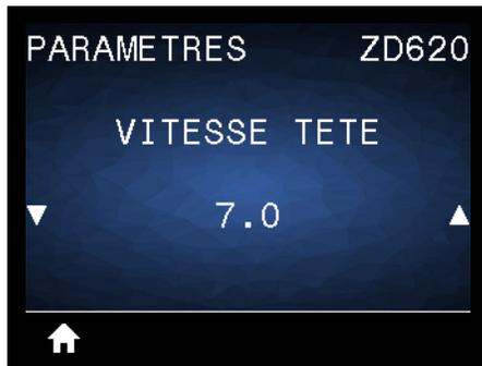
**Description :** sélectionnez la vitesse d'impression d'une étiquette en pouces par seconde (pps). Généralement, plus la vitesse est faible, meilleure est la qualité d'impression.
