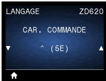
**Description :** cette option permet de changer le préfixe de commande de format. Le préfixe de commande de format est une valeur ASCII (valeur hexadécimale à deux chiffres indiquée entre parenthèses) utilisée comme repère de paramètre dans les instructions de format ZPL/ZPL II. L'imprimante recherche ce caractère de commande indiquant le début d'une instruction de format ZPL/ZPL II.
