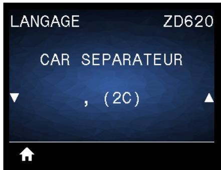
**Description** : cette option permet de séparer des paramètres de commande (délimiteur de commande). Le préfixe par défaut est la virgule (,). L'imprimante recherche ce caractère pour séparer des morceaux de commandes ZPL/ZPL II. Alignez le caractère de séparation sur ce qui est utilisé dans vos formats d'étiquette.
