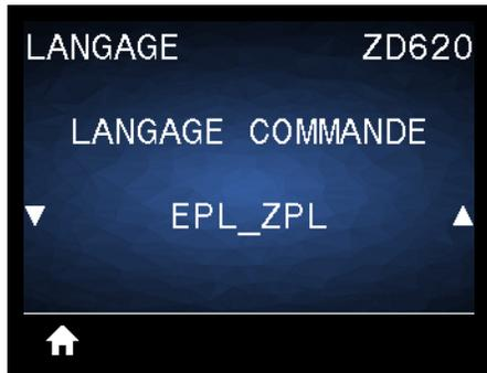
**Description :** ce paramètre vous permet de contrôler les variations du langage de programmation principal disponibles, telles que EPL\_ZPL, EPL (ancien langage), et Hybrid\_XML\_ZPL (utilisées pour compléter les variables des formats/formulaires avec des éléments structurés XML).
