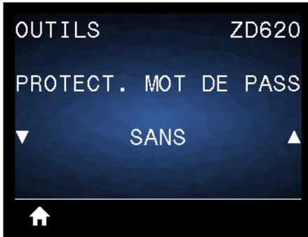
**Description** : sélectionnez le niveau de protection par mot de passe pour les options des menus utilisateur. **1234** est le mot de passe par défaut.
