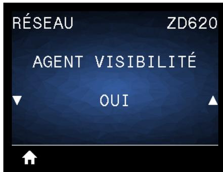
**Description :** lorsque l'imprimante est connectée à un réseau câblé ou sans fil, elle essaie de se connecter au Asset Visibility Service de Zebra via le Zebra Printer Connector basé sur le Cloud au moyen d'une connexion Web chiffrée et authentifiée par certificat. L'imprimante envoie les paramètres et données de découverte et les données d'alerte. Les données imprimées via des formats d'étiquettes ne sont PAS transmises.
