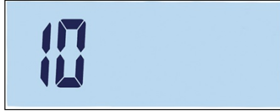
Figure 3-20 : Écran de sélection d'une valeur du zéro à la mise sous tension
